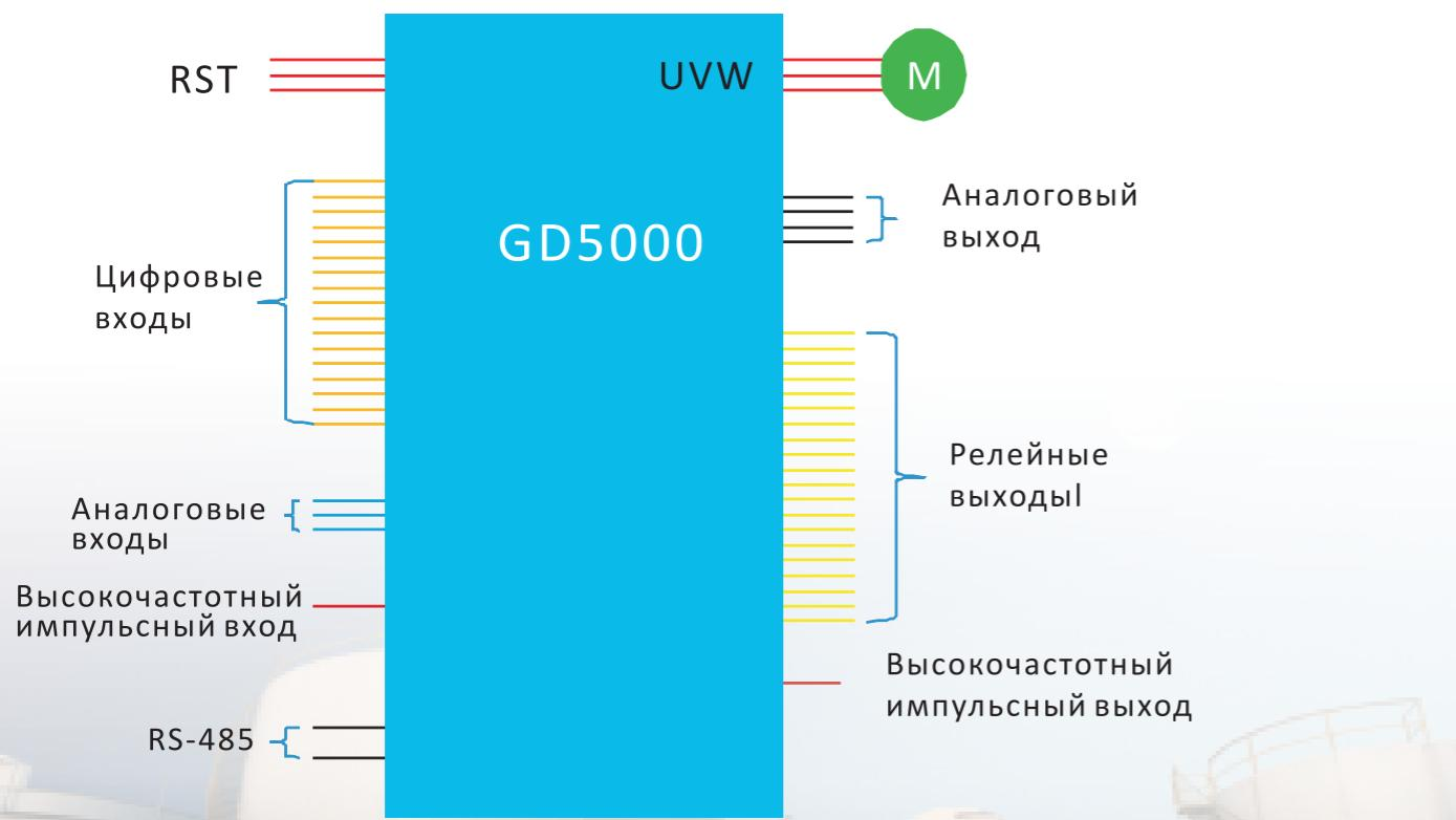
※ Для получения подробных инструкций по подключению клемм высоковольтного преобразователя частоты серии GD5000, обратитесь к общим параметрам или к руководству по эксплуатации, или свяжитесь с INVT ELECTRIC CO., LTD.
